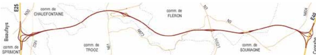
Elle a pour but de terminer le contournement complet de la ville de Liège. Il est prévu que ce raccordement prenne la forme d'une autoroute comprenant deux bandes de circulation (avec possibilité d'en rajouter une troisième)<sup>4</sup> dans chaque sens sur une longueur de 12,5 km.
